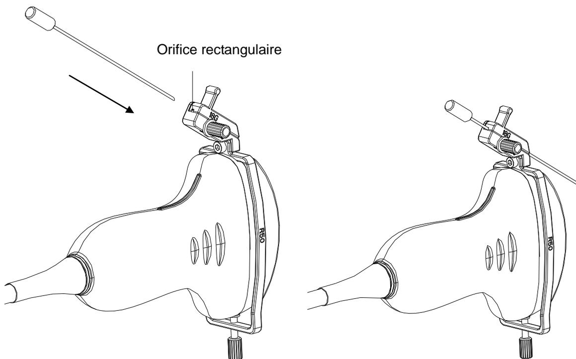
Figure 6-33 Insertion de l'aiguille dans l'orifice rectangulaire
