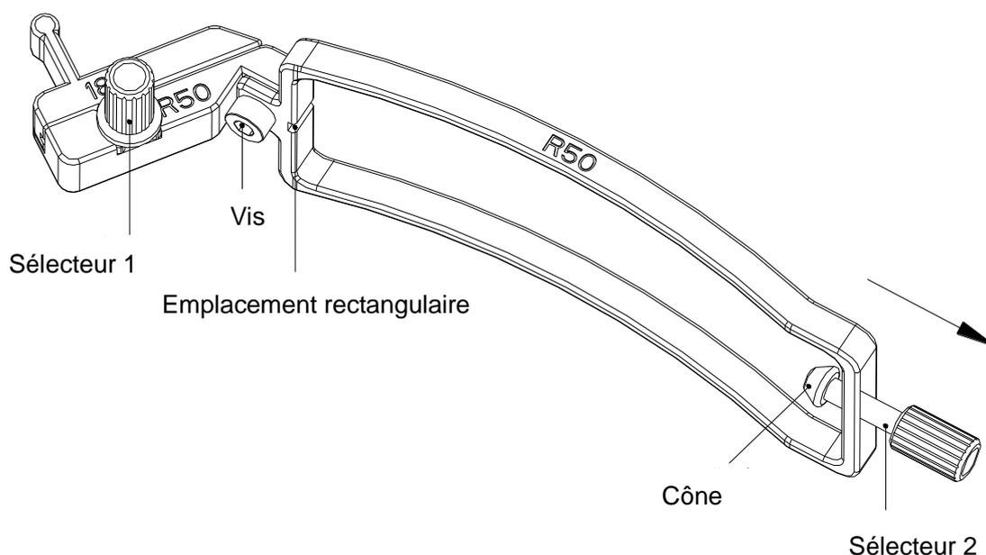
Figure 6-28 Structure du kit de support pour le guidage de l'aiguille
