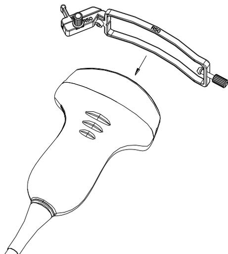
Figure 6-31 Fixation du kit de support à la sonde
