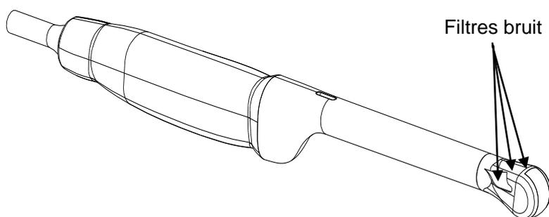
Figure 6-37 Filtres bruit situés sur l'embout de la sonde
