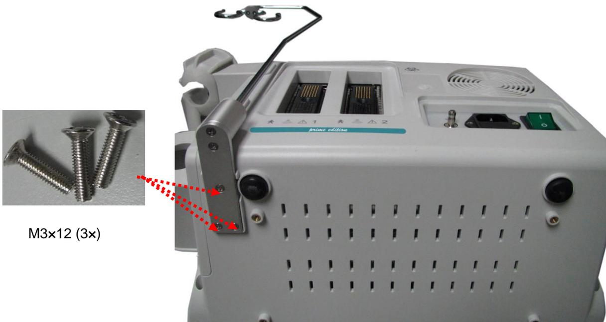
Figure 4-1 Assemblage du support de Câble à l'unité principale
