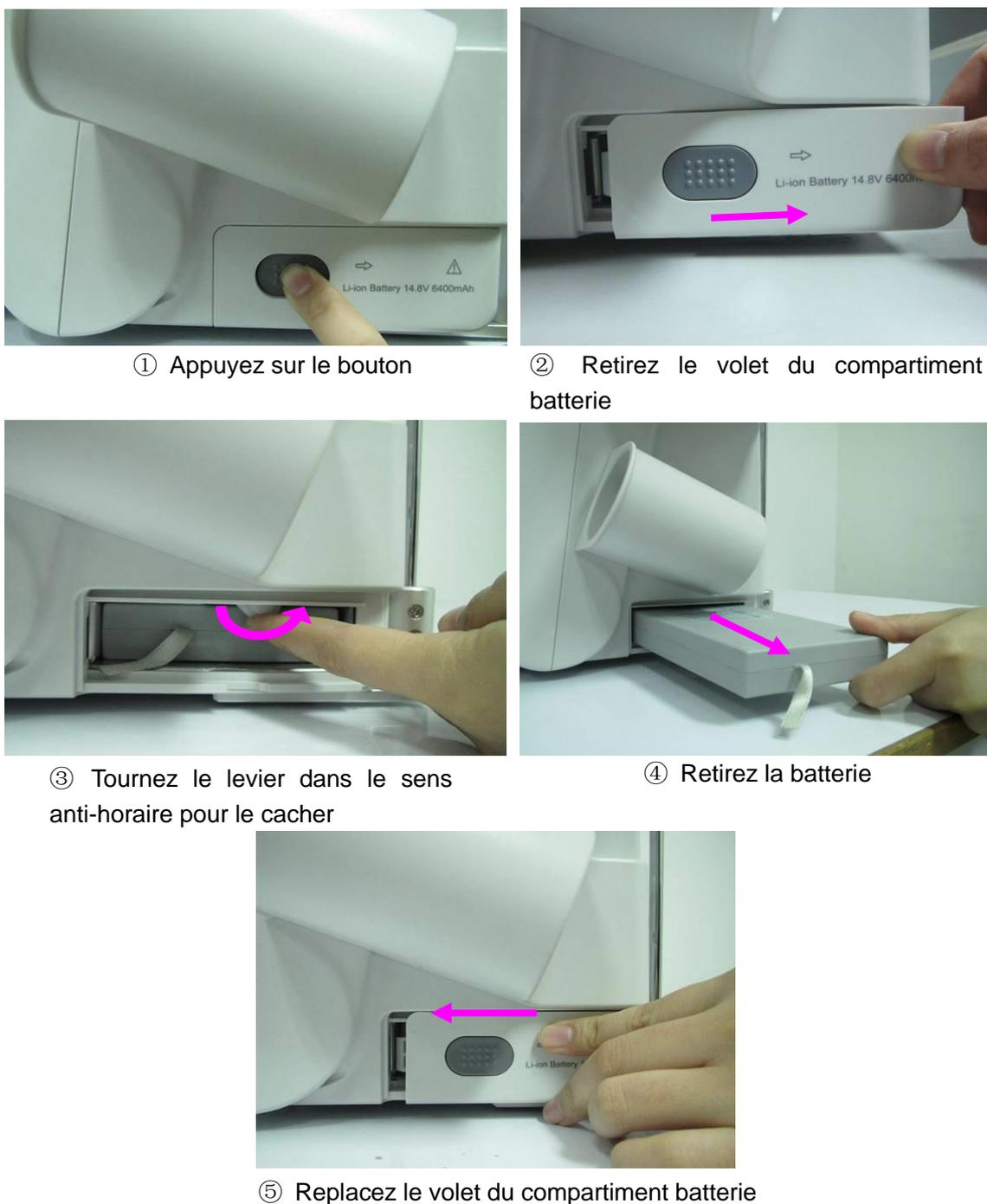
Figure 4-4 Désinstaller la Batterie de l'Unité Principale
