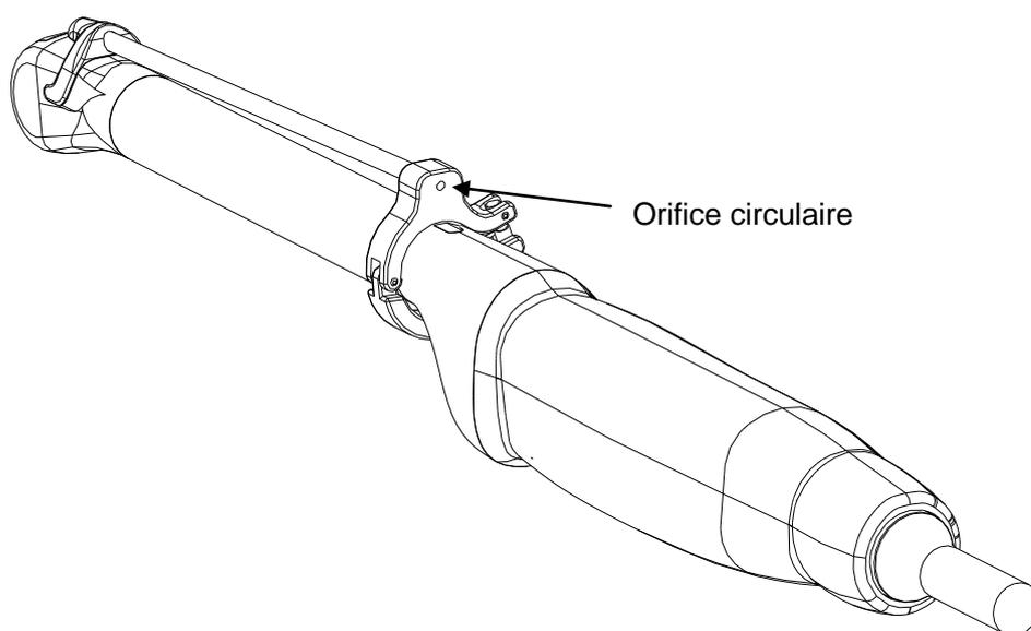
Figure 6-40 Insertion de l'aiguille dans l'orifice circulaire
